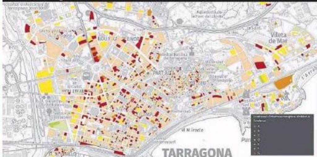
Los resultados de los certificados de eficiencia van desde la marca A (verde) hasta la G (roja). La B refleja una buena eficiencia, la C es correcta, la D implica la existencia de algunas ineficiencias y las construcciones cuya marca esté entre la E y la G, deberían reducir un 40 o 50% su consumo.
